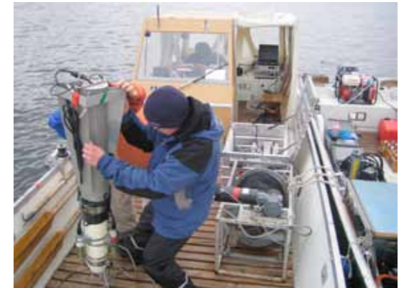
Mit einem „Mikroprofiler“ werden hochauflösende Temperaturprofile im See gemessen. Dadurch lassen sich turbulente Wasserströmungen im See berechnen.
