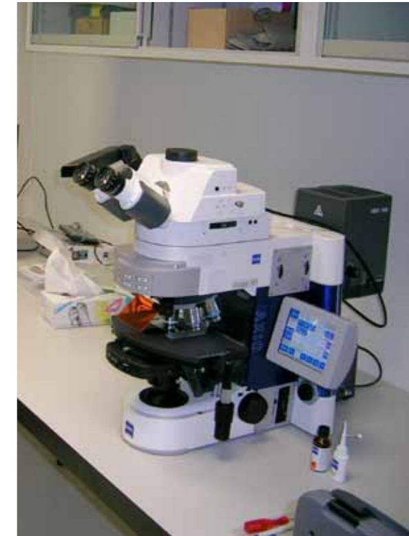
Forschungsmikroskop mit Fluoreszenzeinrichtung zur Zählung von Gewässerbakterien.
