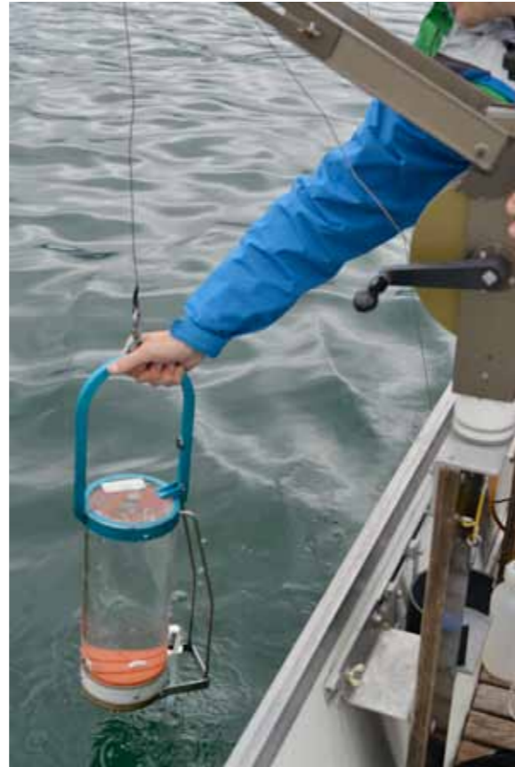
Mittels Wasserschöpfer lassen sich jeweils 5 Liter aus der gewünschten Tiefe an die Oberfläche befördern.
