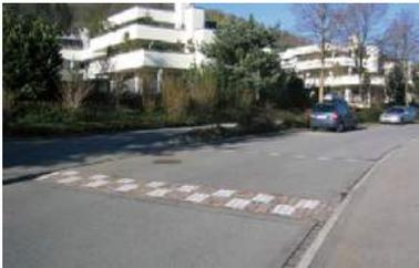
Vertikale Versätze zwingen den Autofahrer zu einer verlangsamten Geschwindigkeit. Sie haben eine sehr gute Wirkung auf die Geschwindigkeit des motorisierten Verkehrs. Zudem können vertikale Versätze auch als Querungshilfe benutzt werden. Ein Konflikt besteht in der Regel, wenn auf dem Abschnitt eine Buslinie verkehrt und bei unübersichtlichen Stellen, wo der Autofahrer den vertikalen Versatz nicht frühzeitig sehen kann. Zudem ist die Akzeptanz bei Radfahrern eher gering.
